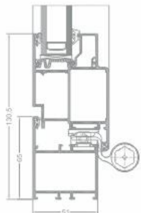
EL panelajtó keresztmetszet
